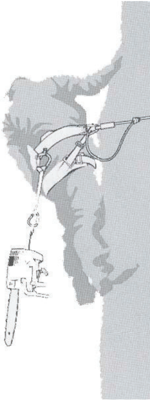
Obrázok A.2 — Príklad uchytenia reťazovej píly pre ošetrovanie stromov na stredovom zadnom bode stroja
